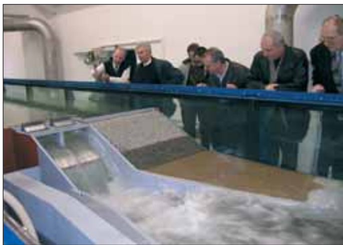
V proskleném žlabu se může otestovat, jak se bude chovat funkční objekt a hráz vodního díla Znojmo až při desetitisíciletém průtoku vody Q_{10\,000} .
